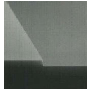
段差(1 \mu m)表面拡大写真
