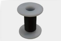
100m以上の長距離糸化技術 (熱電発電素子：CNT系)
