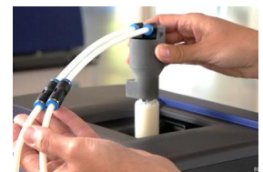
チューブポンプで粉砕機より 分散液を自動採取
